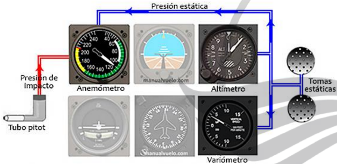
Fig.222 - Sistema de pitot, presión de impacto y presión estática.
