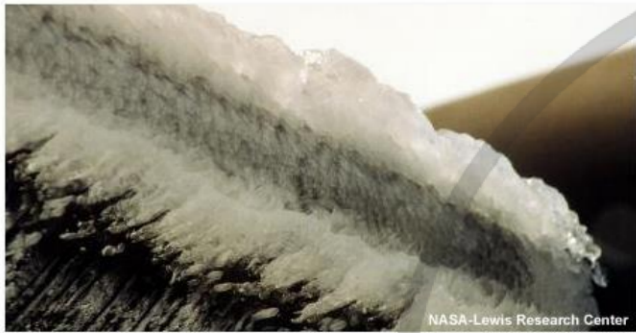
Fuerte acumulación de hielo en el ala de un avión
